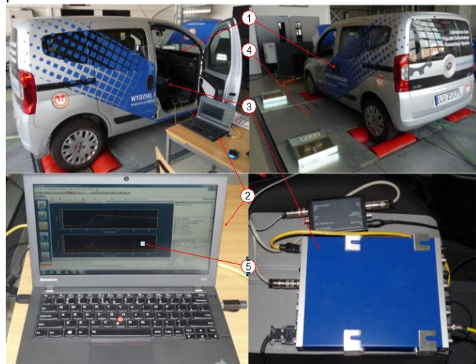
Rys. 1. Stanowisko badawcze: 1. Samochód badawczy Fiat Qubo z silnikiem 1.3 Multijet z dodatkowym układem paliwowym 2. Komputer z zainstalowanym oprogramowaniem AVL 3. System do indykowania silnika AVL Indimicro 602 4. Hamownia podwozowa DF4FS-HLS 5. Oprogramowanie AVL IndiCom V2.7.
