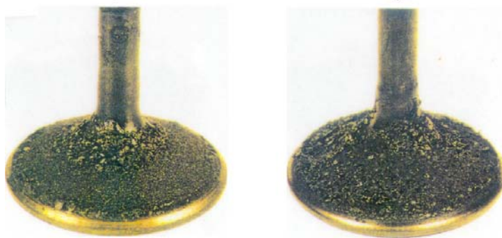
Rys. 7. Osady na zaworach dolotowych silnika testowego
