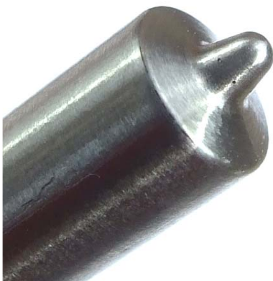
Rys. 5. Końcówka rozpylacza nowego wtryskiwacza.
